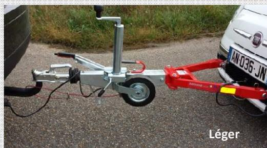
Le cadre à tracter **REMORA** est un système novateur qui s'accroche d'une part sur la boule d'attelage comme une remorque et d'autre part sur la voiture tractée par deux points fixes sur le pare-choc avant (ancrage sécurisé par boulonnage sur le châssis). **REMORA** est composé de deux éléments : le premier est posé de façon permanente sur la voiture à tracter, l'autre est constitué du timon amovible.
